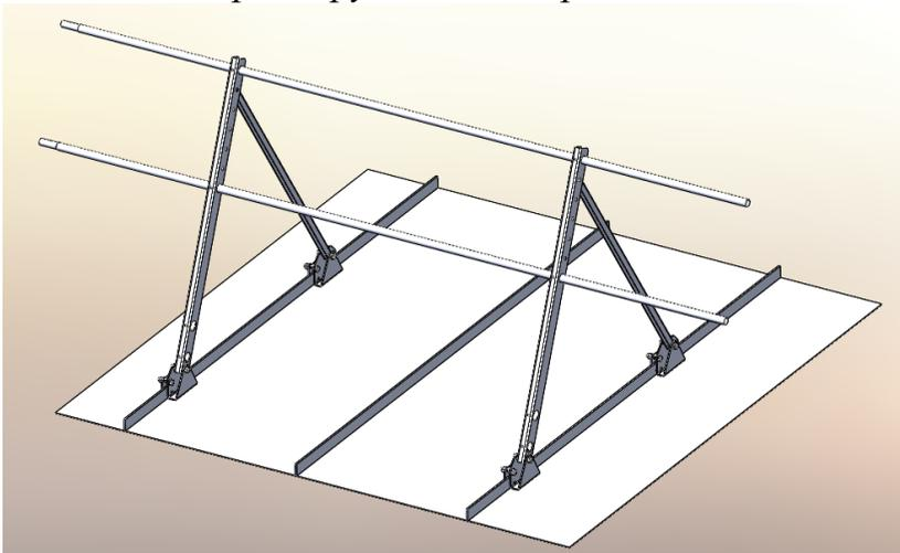
4. При соединении между собой соседних секций ограждения обжатые концы одной секции вставляются в свободные концы другой секции.
